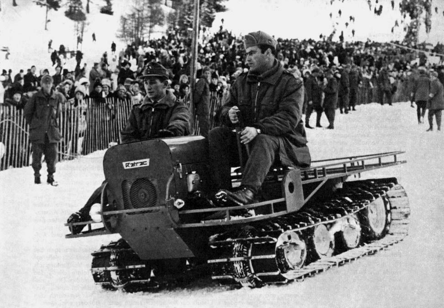
Festigung der Schneedecke mit „RATRAC“-Überschnee-Raupenfahrzeugen der Firma Dr. K. Schleuniger & Co., Zürich
